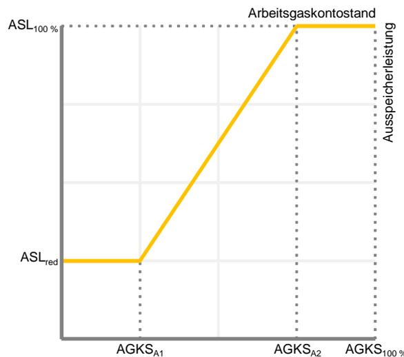
Die maximal nutzbare *Ausspeicherleistung* unterliegt folgender Kennlinienrestriktion:
