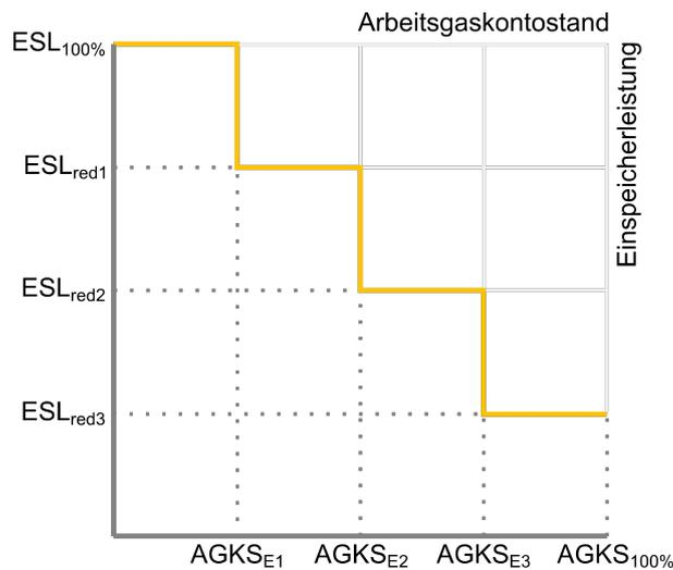
Die maximal nutzbare *Einspeicherleistung* unterliegt folgender *Kennlinienrestriktion*:
