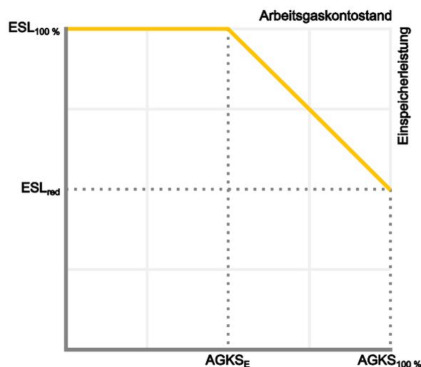
Die maximal nutzbare *Einspeicherleistung* unterliegt folgender Kennlinienrestriktion:
