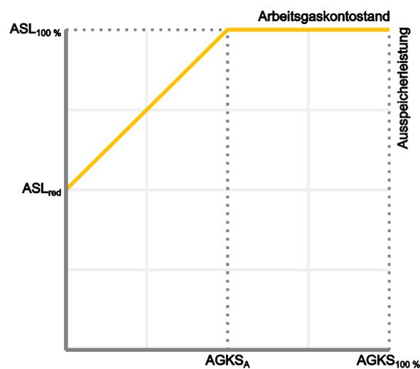
Die maximal nutzbare *Ausspeicherleistung* unterliegt folgender Kennlinienrestriktion:
