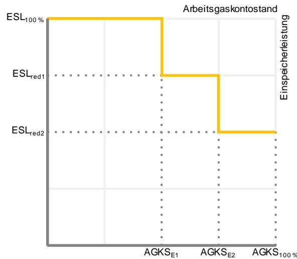
Die maximal nutzbare *Einspeicherleistung* unterliegt folgender Kennlinienrestriktion:
