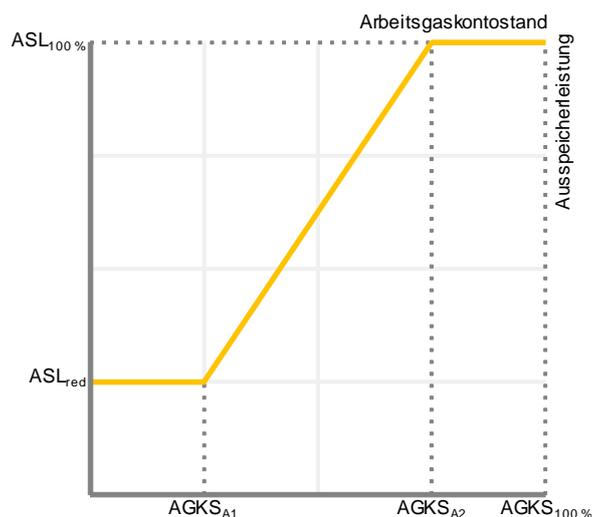
Die maximal nutzbare *Ausspeicherleistung* unterliegt folgender Kennlinienrestriktion:
