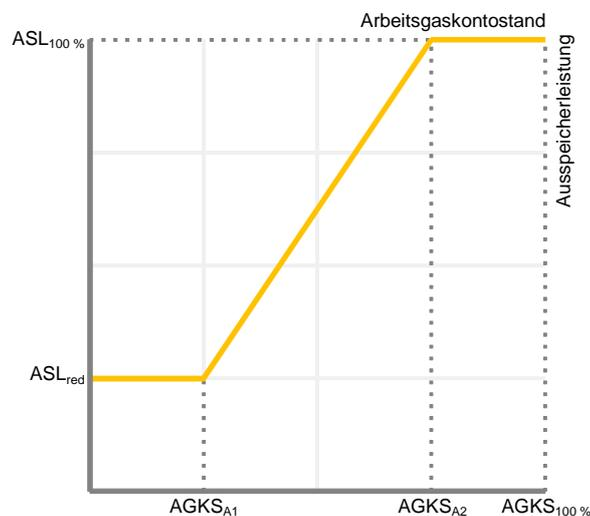
Die maximal nutzbare *Ausspeicherleistung* unterliegt folgender Kennlinienrestriktion:
