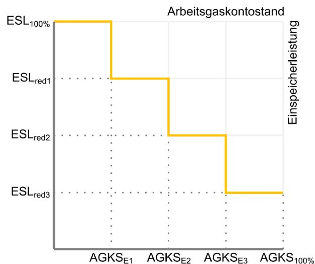
Die maximal nutzbare *Einspeicherleistung* unterliegt folgender Kennlinienrestriktion:
