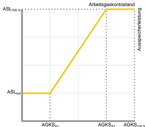
Die maximal nutzbare *Ausspeicherleistung* unterliegt folgender Kennlinienrestriktion:
