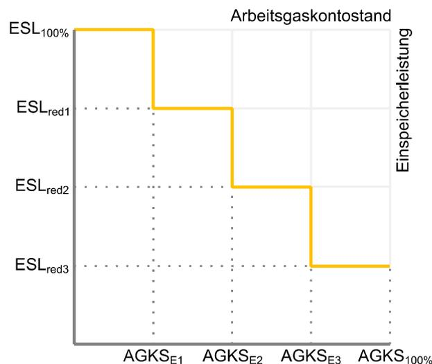
Die maximal nutzbare *Einspeicherleistung* unterliegt folgender Kennlinienrestriktion:
